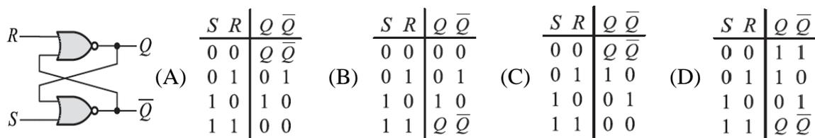
2. 【    】 數位邏輯實驗時，若以邏輯閘完成了如圖所示之電路，則此電路之功能與下列哪個正反器較相符？
