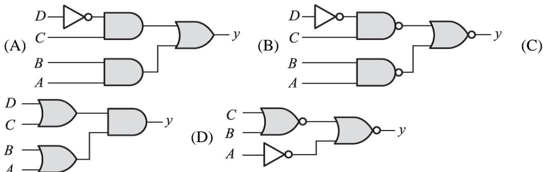
28. 【】 布林代數式  $y = \bar{A}\bar{C} + \bar{C}\bar{D} + A\bar{C} + \bar{A}C\bar{D} + \bar{A}\bar{B}D + \bar{A}BD$  的最簡式為何？
