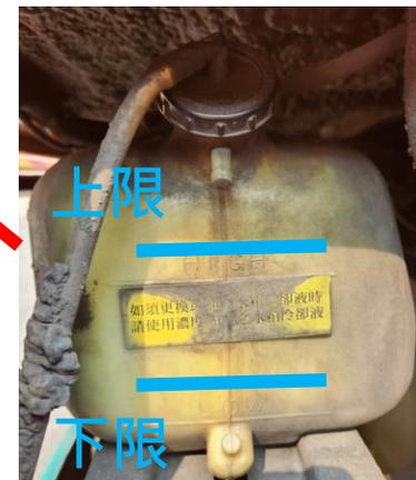
冷卻水液面高度
